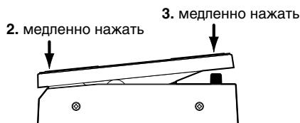
Например, назначьте PEDAL FX на VOLUME, установите значение VOL PEDAL MIN в 0 и проверьте минимальный уровень в крайнем положении педали.
