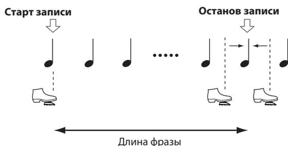
Для отключения функции квантования, перед записью подержите в течении примерно двух секунд нажатой педаль TRIGGER/TAP. При этом кнопка METRONOME погаснет и квантование выключится.
