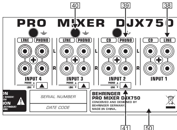
[38] Эти LINE/CD-входы предназначены для подключения магнитофонов, проигрывателей CD или MD и др. В отличие от других каналов, канал 1 имеет два линейных входа.
